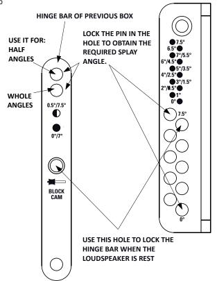
LOUDSPEAKER SPLAY ANGLES SET UP
