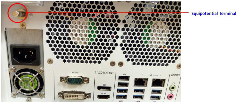
Figure 2-8: MED-AS402 Equipotential Terminal Pin
