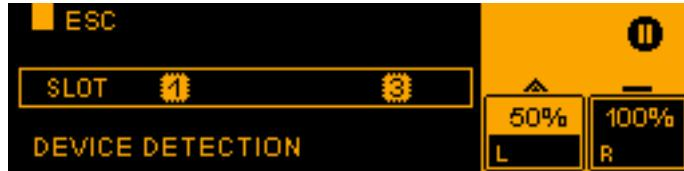
Выполняется распознавание устройства, на дисплее отображается, в каком гнезде расширения обнаружено устройство с протоколом управления коммуникацией.
