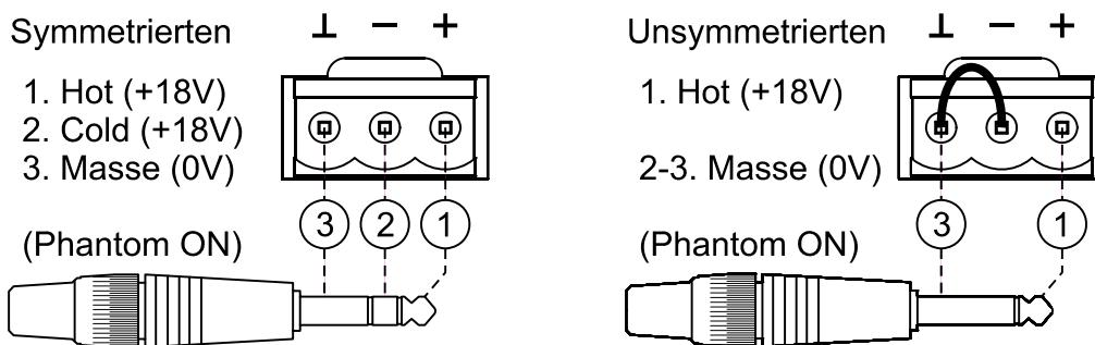
Die Mikrofone müssen eine geringe Impedanz besitzen (200 - 600Ω) und Mono sein.
