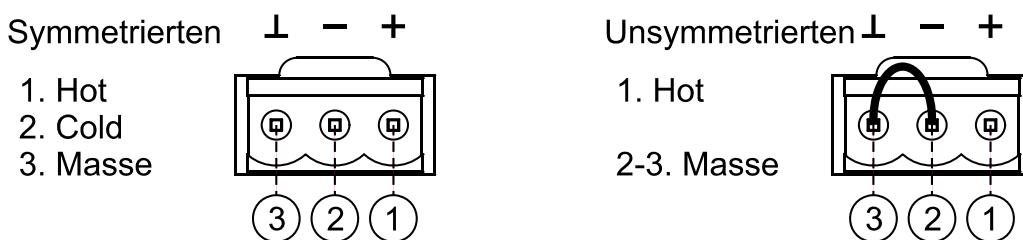
Soll der Ausgang unsymmetrisch genutzt werden, so müssen die Anschlüsse 2 und 3, wie im vorigen Diagramm gezeigt, kurzgeschlossen werden. Geschieht dies nicht, so hat das ausgehende Signal weder den geeigneten Pegel noch die geeignete Qualität.
