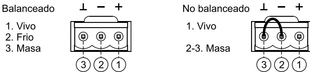
En caso de querer usar la salida en modo no balanceado es preciso cortocircuitar los terminales 2 y 3, tal y como indica el diagrama anterior. De no hacerlo así la señal de salida no tendrá el nivel ni la calidad adecuados.
