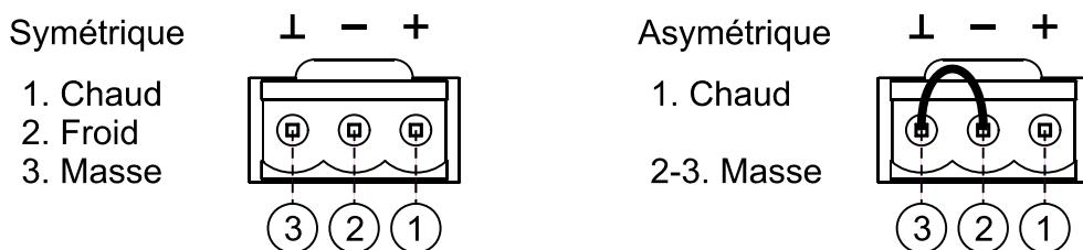
Pour utiliser la sortie en mode asymétrique, il faut court-circuiter les broches 2 et 3, comme indiqué dans le schéma précédent. Sinon, le signal de sortie n'aura pas le niveau ni la qualité adéquats.
