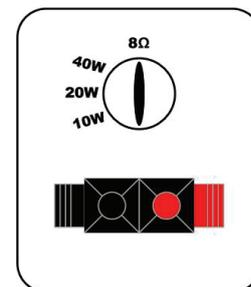
После выбора соответствующего значения выходной мощности АС готова к работе.
