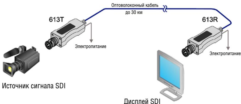
Рис. 2. Оптоволоконная система передачи сигналов HD-SDI 3G 613T/613R
