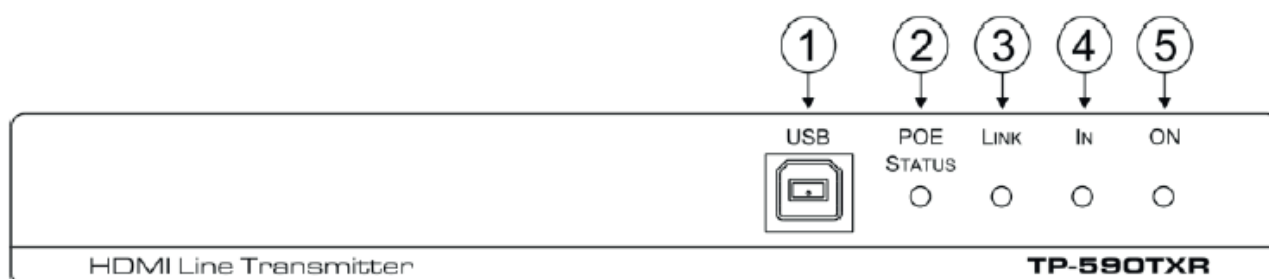
Рис. 1. Вид передней панели TP-590TXR
