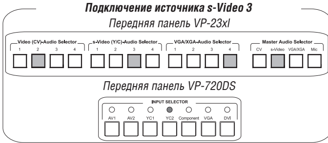
Рисунок 5. Пример 2: коммутация кнопками на передней панели
