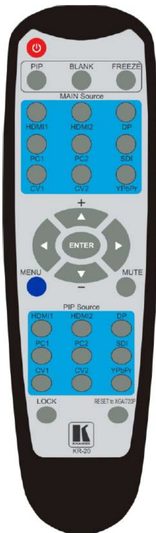
Рис. 31. Инфракрасный пульт дистанционного управления
