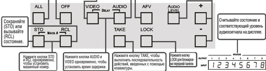
Управляйте устройством с помощью кнопок передней панели, RS-232, RS-485 и/или Ethernet.
