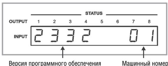
Рис. 9. Вид дисплея состояния через 5 секунд после включения
