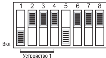
Рис. 1. Установка DIP-переключателей для отдельного устройства
