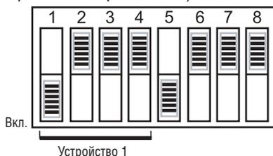
Рис. 1. Установка DIP-переключателей для отдельного устройства
