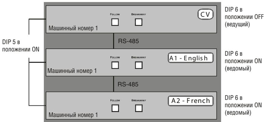
Рис. 9. Подключение в настройке конфигурации ведущий/ведомый
