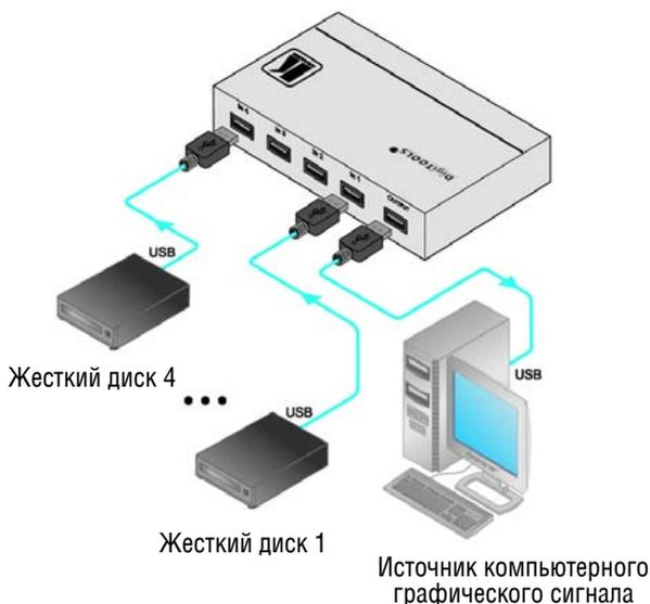
Рис. 2. Подключение USB-коммутатора 4 x 1 VS-41USB
